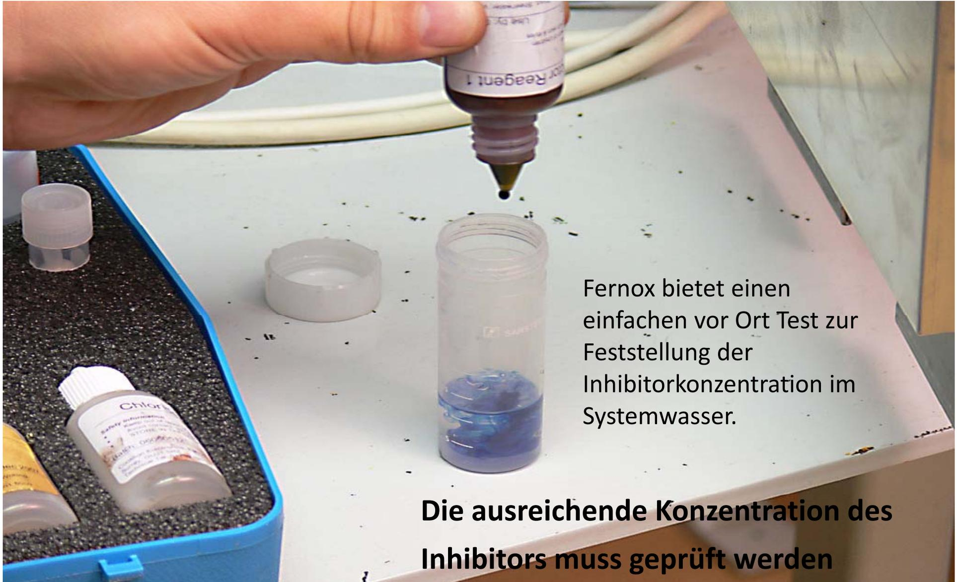
Fernox bietet einen einfachen vor Ort Test zur Feststellung der Inhibitorkonzentration im Systemwasser.
