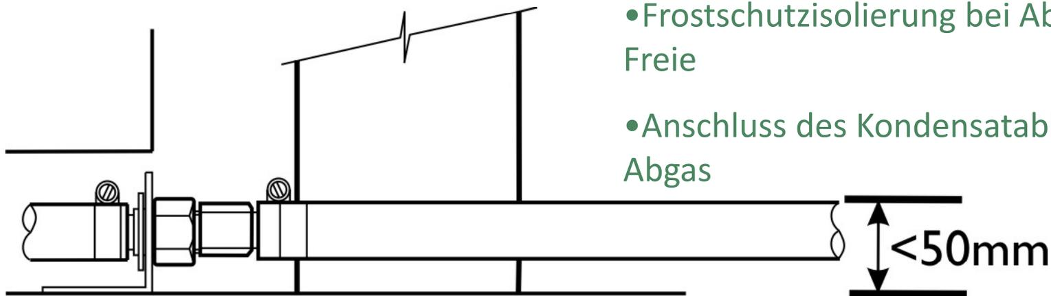
Empfohlene Montage der Kondensatleitung am Gerät
